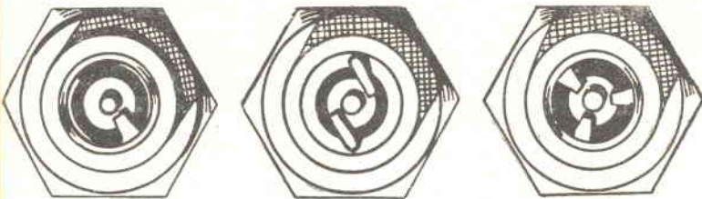
Fig. 2. — Una candela può disporre di uno o più elettrodi di massa. Maggiore è il numero degli elettrodi di massa, più difficilmente si verificheranno incrostazioni.
